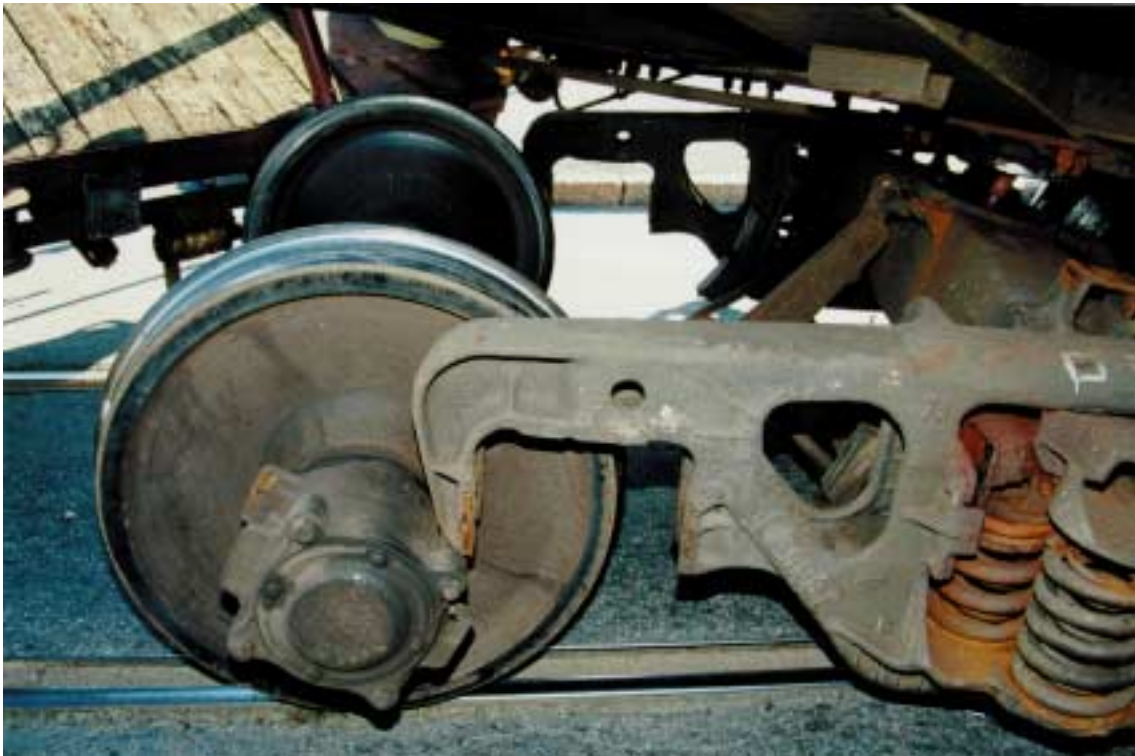
Kuva 6. Kemikaalivaunun suistuminen raiteilta Helsingin Länsisatamassa 5.9.1998. Venäläisen vaunun purkautunut teli.
