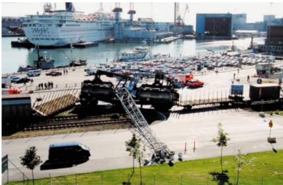
Kuva 1. Junan kulkiessa kaarteessa kiskot levisivät junan alla sillä seurauksella, että junan neljännen vaunun takatelin kulkusuunnassa oikeanpuoleiset pyörät putosivat kiskon vasemmalle puolelle. Suistuneen telin saapuessa seuraavaan vaihteeseen telin vasemmanpuoleiset pyörät nousivat kiskon yli vasemmalle. Koska vaihde oli lukittuna suoralle raiteelle, neljännen vaunun etuteli ohjautui suoraan ja takateli ohjautui raiteiden vasemmalla puolella vasemmalle kääntyvän raiteen suuntaan.
