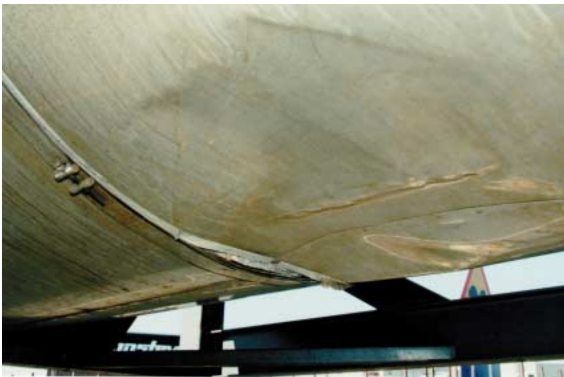
Kuva 9. Kemikaalivaunun suistuminen raiteilta Helsingin Länsisatamassa 5.9.1998. Painuma nestesäiliön vuorauksen pohjassa.
