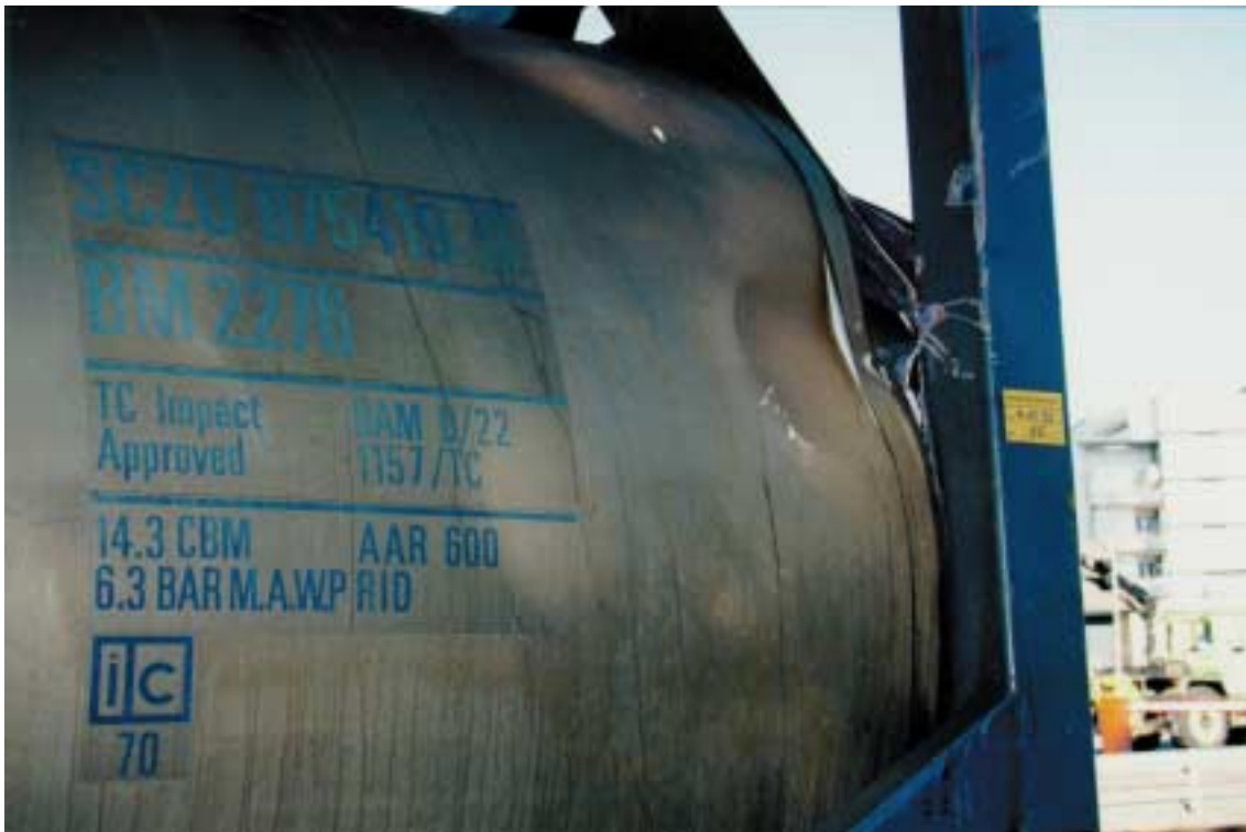
Kuva 8. Kemikaalivaunun suistuminen raiteilta Helsingin Länsisatamassa 5.9.1998. Painuma nestesäiliön vuorauksessa ja naarmuja kontin kehikossa.
