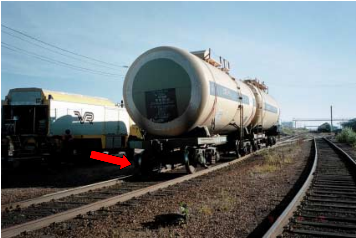
Kuva 3. Säiliövaunun suistuminen kiskoilta Haminan satamassa 19.9.1999. Kiskolta suis- tunut pyörä nuolen osoittamassa kohdassa.
