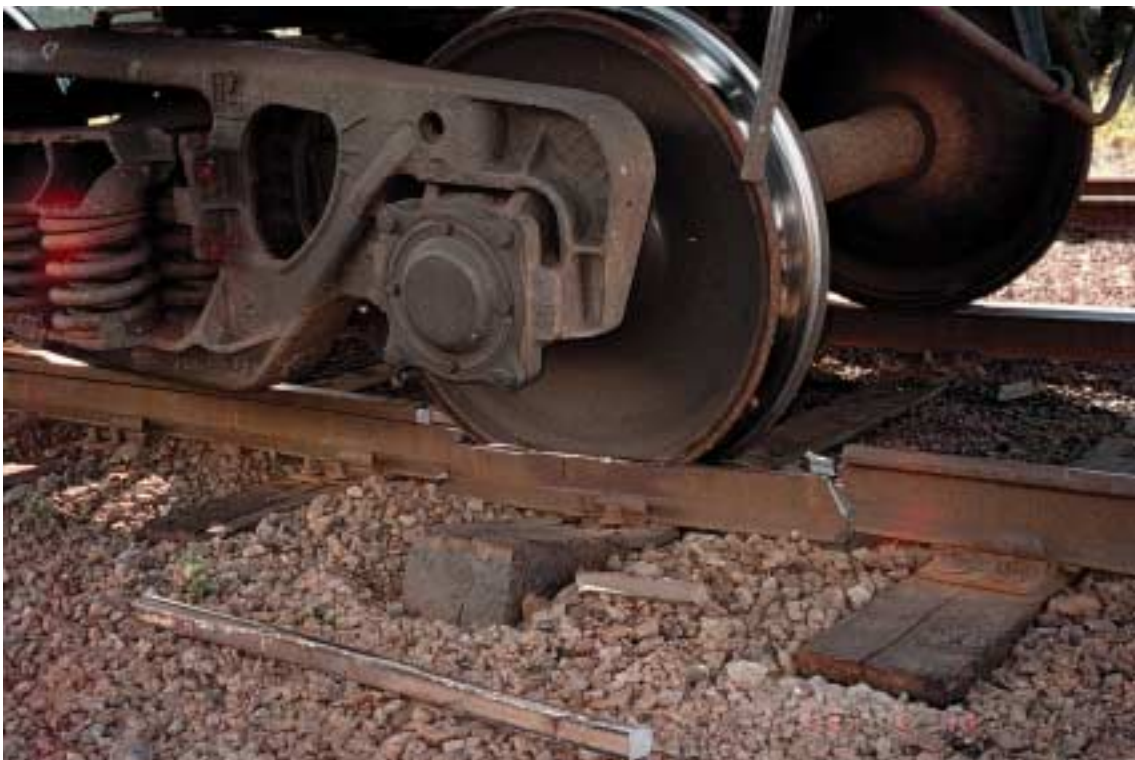
Kuva 4. Säiliövaunun suistuminen kiskoilta Haminan satamassa 19.9.1999. Metanolivau- nun ensimmäisen akselin toinen pyörä katkaisi kiskon ja sen alla olleen ratapöl- kyn.
