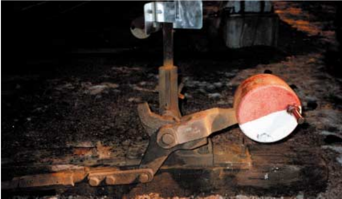
Kuva 2. Säiliövaunujen suistuminen Sköldvikissä 24.11.1998. Vaihde V014, jossa vaunut suistuivat, oli onnettomuuden jälkeen sivulle johtavassa asennossa, mutta ei ollut täysin ääriasennossaan eikä lukittuneena.
