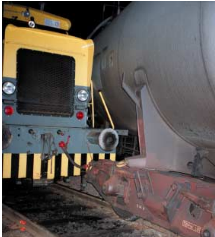
Kuva 3. Säiliövaunujen suistuminen Sköldvikissä 24.11.1998. Ensimmäisenä suistunut vaunu osui kylki edellä viereisellä raiteella seisseeeseen ratakuorma-autoon Tka7. Juna pysähtyi juuri ennen vaunun takatelin törmäämistä Tka:n etuosaan.
