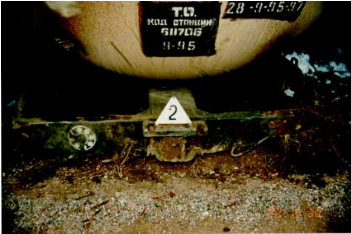
Kuva 5. Reikä neljäntenä olleen vaunun (Vgobo 50625425) säiliön päädyssä.
