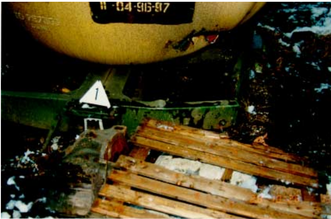
Kuva 6. Reikä seitsemäntenä olleen vaunun (Vgobo 50683218) säiliön päädyssä.
